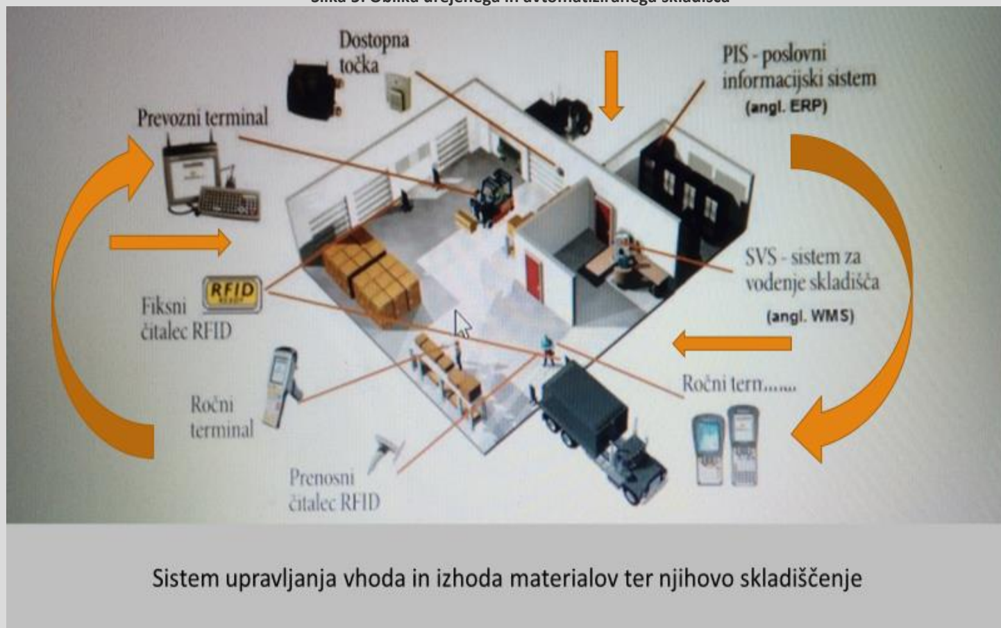
Slika 5: Oblika urejenega in avtomatiziranega skladišča
